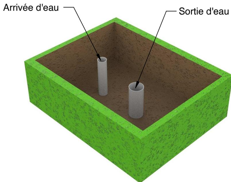
Construire la base de la fontaine au sol en laissant les tubes d'entrée et de sortie de l'eau hors de terre.
