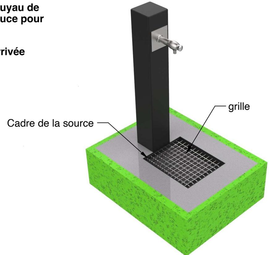
S'assurer de l'activation et du fonctionnement des deux canalisations une pour la conduite d'entrée d'eau et l'autre pour le drainage, avant de bétonner.
